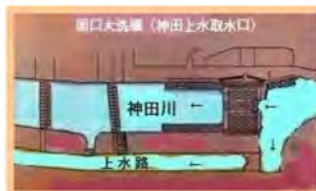
(上) 関口大洗堰。目白関口に堰を設け、神田川の水を上げて取水し、石樋や木樋で地下を通し、江戸に飲料水を供給した。
